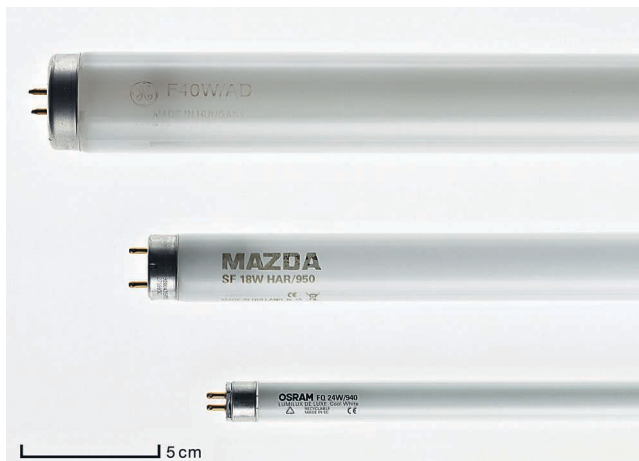
Fig. 4. Tubes luminescents à cathode chaude sous tension secteur ou « tubes fluorescents » diamètre 38 mm, 26 mm, 16 mm. © C2RMF/Anne Maigret.
