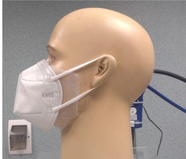
Figura 2. Fotografía del maniquí adaptado para la realización de los ensayos de protección respiratoria.
