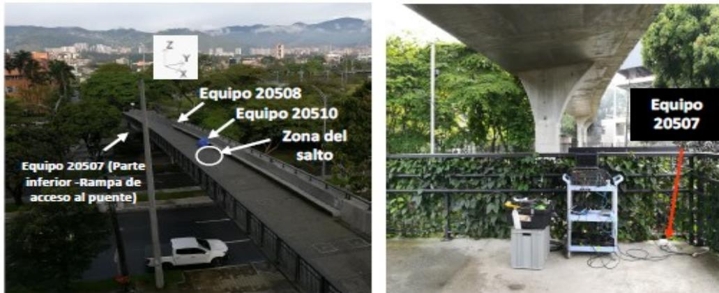
fotografía 7-3 Disposición de los acelerómetros en el puente peatonal (Fernández L.D et al., 2020).
