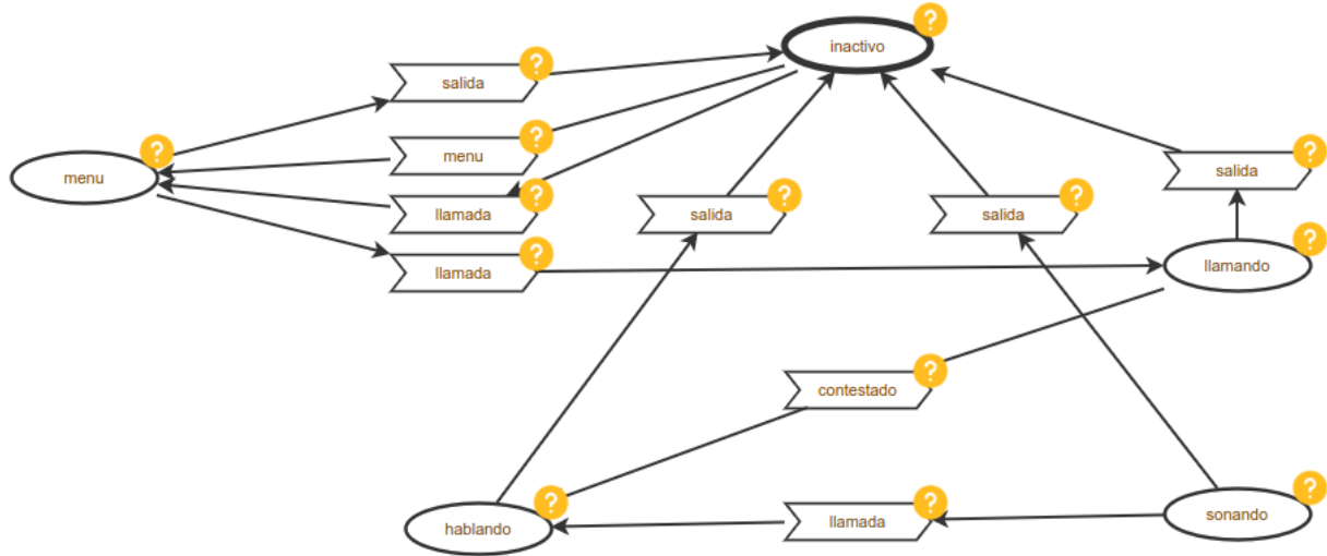
FIGURA 3.2: Diagrama de transiciones de una línea de un celular. [27]
