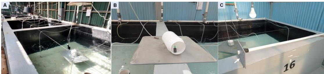
Gambar 10. Alat pengaduk telur vaname. A-B. Pengaduk otomatis (panah hitam), C. Pengaduk manual (panah putih)
