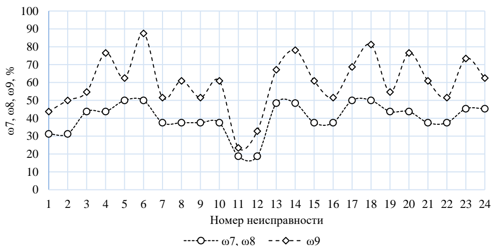
Рис. 7. Графическое изображение показателей \omega_7, \omega_8, \omega_9 для различных неисправностей тестовой схемы
