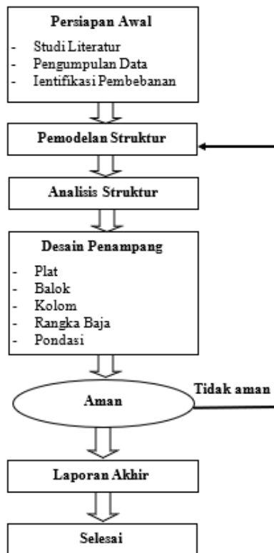
Gambar 14. Bagan alir perencanaan struktur gedung
