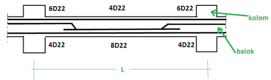
Gambar 7. Pemasangan tulangan balok
