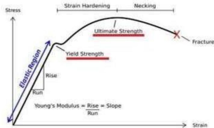
Gambar 3.5 Stress – Strain Kurva untuk Bahan Elastis (Sumber. www.wikipedia.com/YildStrength )
