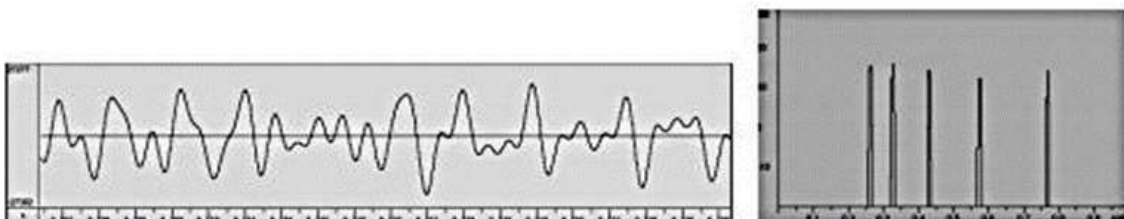
Fig 14. Sonido y espectro inarmónico.
