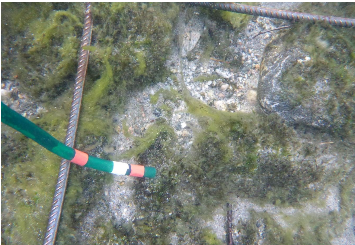
Bilde 1. Måling av hulrom i elvebunnen skjedde ved hjelp av fleksibel plastslange i henhold til metode beskrevet av Finstad et al. (2007). Foto: Jan Gunnar Jensås.
