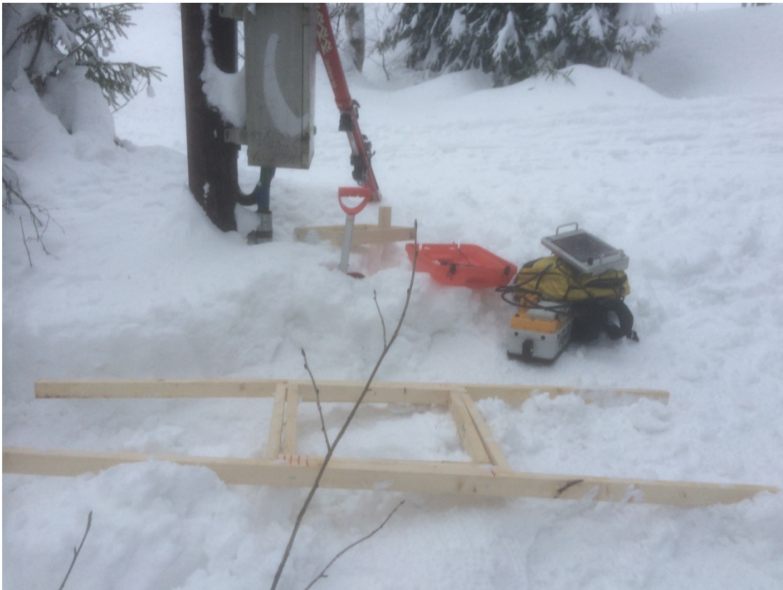
Figur 3. 800 MHz antenne og treramme for å holde antenne opp i lufta og bære langs profilet.
