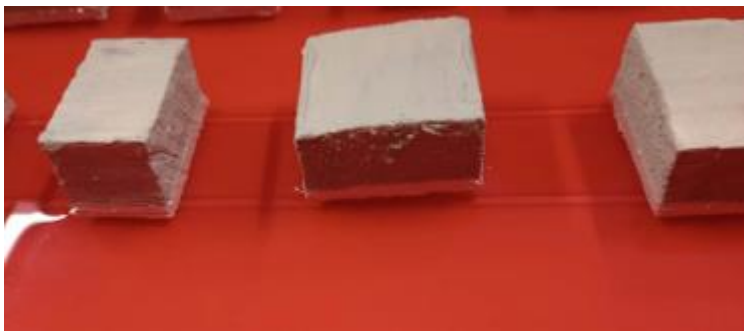
Figur 13 Prøveklosser oppå glasstaver i kontakt med vann. Foto: Tor Martin Steine Lohne
