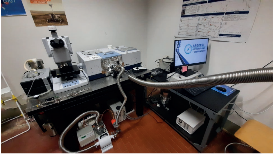
Figura 1. Setup di irraggiamento UV presso il Laboratorio di Astrobiologia dell'Osservatorio Astrofisico di Arcetri.
