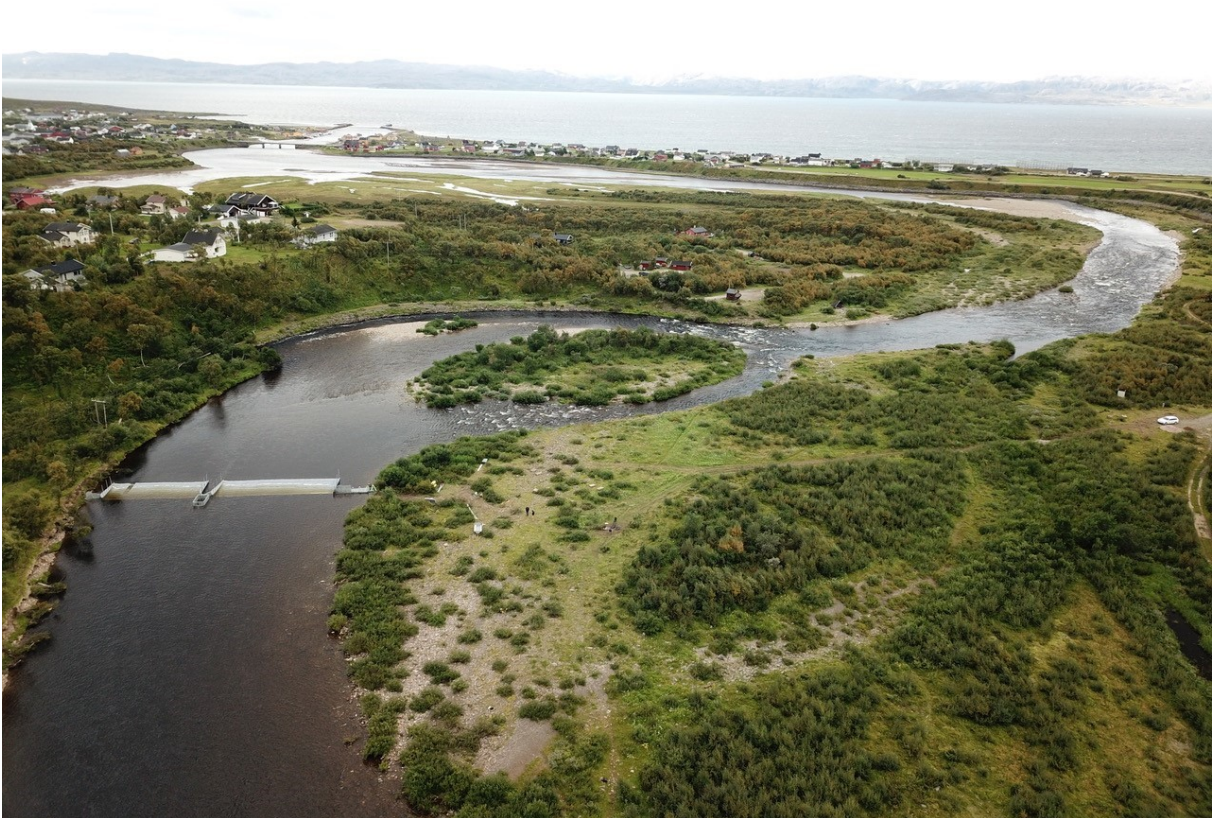
Kuva 9. Kyttyrälohien pyyntiin rakennettu poikkipato toiminnassa Finnmarkin Vestre Jakobselva joella. Kuva: Jan Harald Tomassen.
