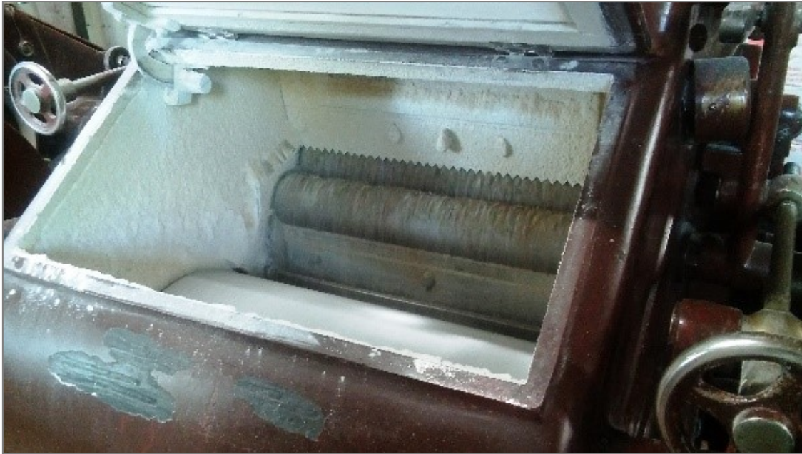
Abbildung 62: Der Walzenstuhl – Herzstück der Mehlerarbeitung. 801
