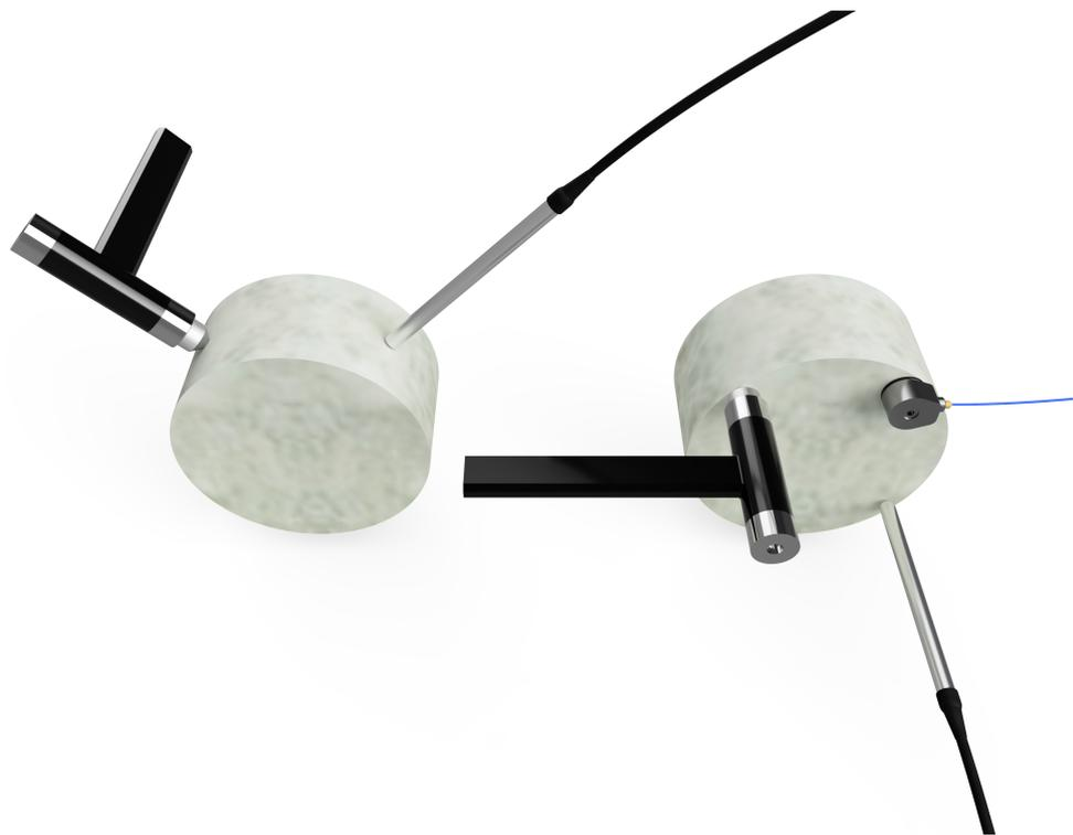
Abbildung 12.3.: Konstellation der Anregungsposition des Impulshammers und der Messpositionen des Beschleunigungssensors sowie des Nahfeldmikrofons zur Anregung der ausgewählten Eigenmoden der untersuchten zylindrischen Betonprobekörper sowie zur Messung der zugehörigen Eigenfrequenzen;
