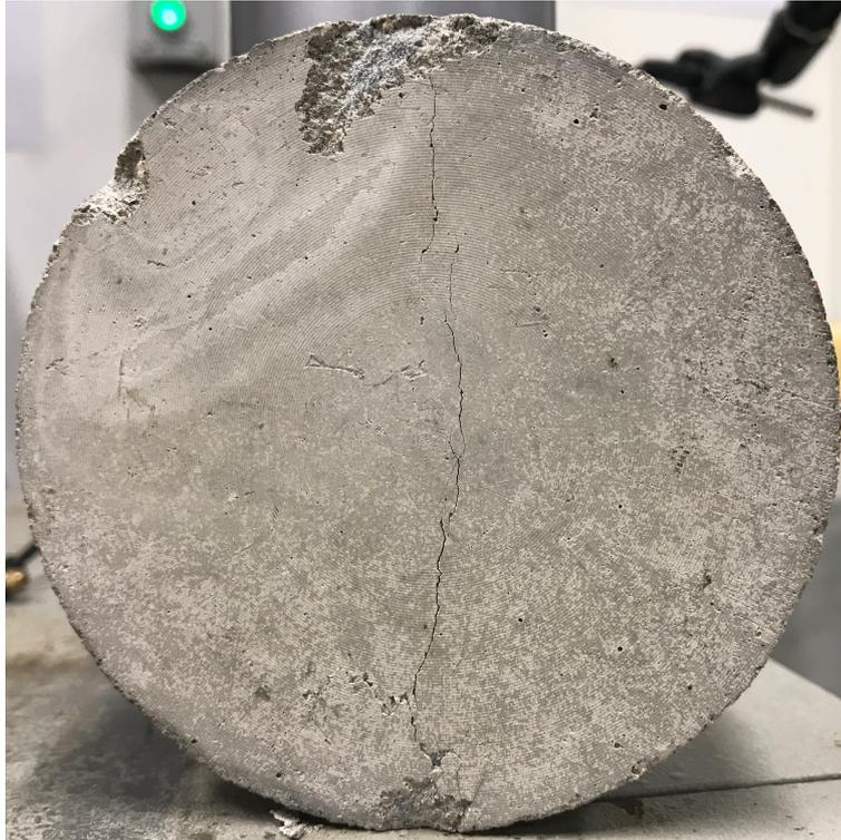
Abbildung 13.2.: Nicht vollständig versagter Probekörper nach Versuchsende mit deutlich sichtbarem Makroriss
