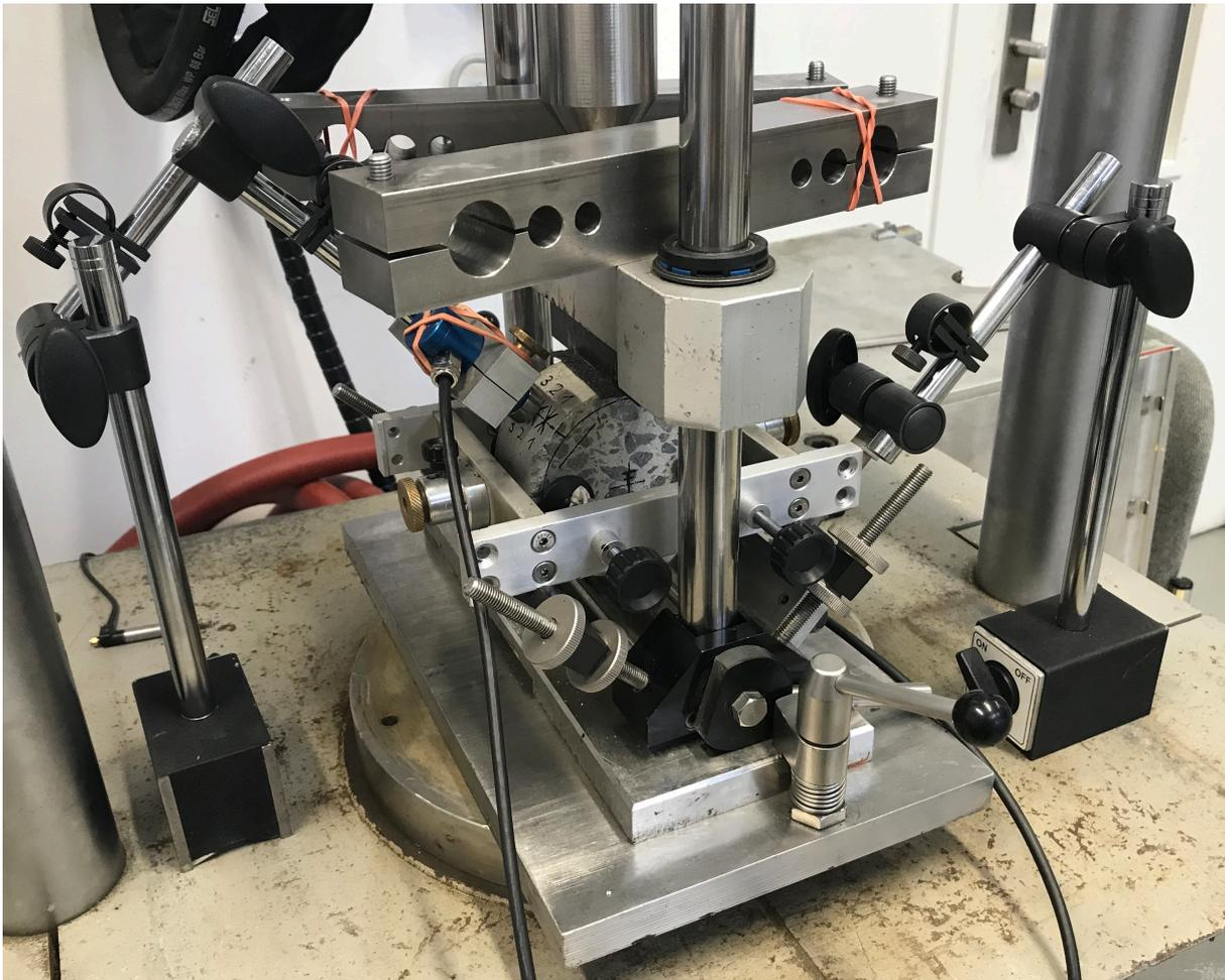
Abbildung 12.2.: Anwendung des Ultraschalllaufzeit- und des Ultraschalleigenfrequenzverfahrens im Winkel von  $135^\circ$  am Probekörper, eingebaut in die Versuchsvorrichtung des Spaltzug-Schwellversuchs
