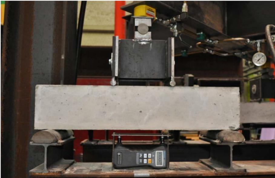
Abbildung 8.3.: Ultraschalllaufzeitmessung der Ausbreitungsgeschwindigkeit der Rayleighwelle an einem Vierpunkt-Biegebalken unter zyklischer Beanspruchung nach Breitenbücher und Kunz [63]
