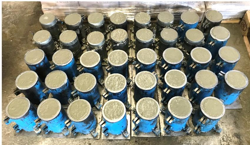
Abbildung 12.4.: Betonprobekörper der Betonrezeptur 1 mit einem Durchmesser  $d_{zyl} = 100\text{ mm}$  und einer Höhe  $h_{zyl} = 200\text{ mm}$  nach der Herstellung mittels zylindrischer Schalformen aus Stahl
