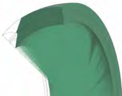
Рис. 6. Форма шарнира с равноупругостью резиновых слоёв по результатам моделирования [получены авторами].
