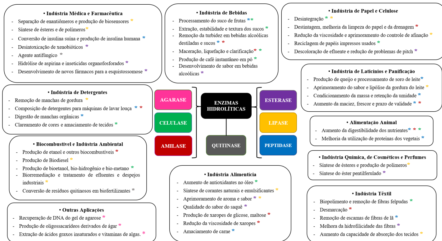
Fig. 1: Panorama geral das aplicações industriais das hidrolases agarase, celulase, amilase, esterase, lipase, protease e quitinase. Os quadros indicam os diferentes setores industriais e os asteriscos coloridos indicam qual a respectiva enzima utilizada na aplicação apresentada.
