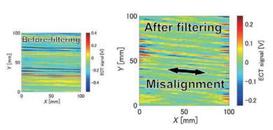
CFRP におけるミスアライメント層の抽出 Extraction of misalignment layer in CFRP
