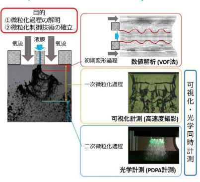
平面液膜式燃料噴射弁による液膜微粒化過程 Atomization process of a liquid film by planar air-blast atomizer 微粒化過程の素過程と各過程の相互作用に着目し、数値解析、可視化計測、光学計測や理論解析を協調して行うことで、気流による液膜微粒化過程の解明と微粒化制御技術の確立を目指している。
