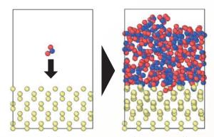
CVD 成膜シミュレーション (SiH<sub>2</sub>のみ供給) CVD simulation (Supply only SiH<sub>2</sub>)
