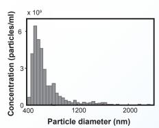
電気抵抗による粒径計測 Particle size measurement by electrical resistivity
