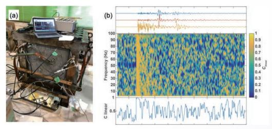
(a) 注水時の地震を模擬した岩石実験装置, (b) 3 成分時微小地震計から求めた粒子軌跡の直線性評価結果
