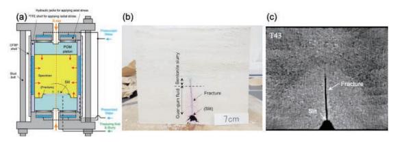
(a) 未固結地層内のフラクチャリング挙動を可視化するために独自に作成した実験装置, (b) フラクチャリング実験結果, (c) フラクチャリング実験のリアルタイム CT 可視化画像 (a) Originally designed apparatus for unconsolidated rock hydraulic fracturing experiment. (b) An example of experiment result. (c) CT scan image of experiment taken in realtime.
