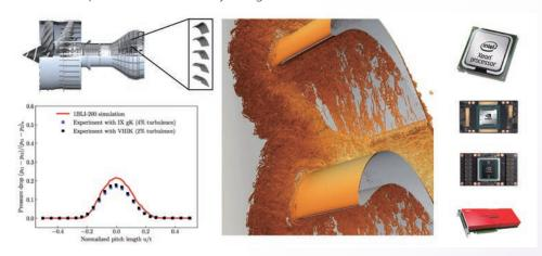
高並列 GPU 計算機を用いたジェットエンジン内部流れの高次精度空力解析 High-fidelity aerodynamic simulation of turbine blade using modern hardwares
