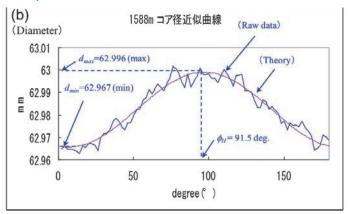
10マイクロメーター精度で測定したコアの変形 (青線) と近似曲線 (ピンク) Circumferential diameter distributions of the core samples in 10 micrometer order (red) and fitted sign curve (pink).
