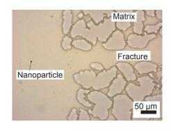
マイクロ流路内の粒子の流れの可視化 Visualization of particle movement in micromodel
