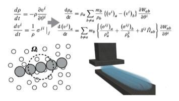
一般座標 SPH による繊維入り 3 Dプリンターの解析 Numerical simulation of fiber-reinforced 3D printing technology using a generalized SPH
