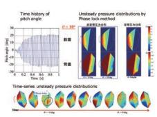
遷音速におけるはやぶさカプセルの 自励振動現象の解明 Study of self-oscillation phenomenon of HAYABUSA capsule in transonic flow
