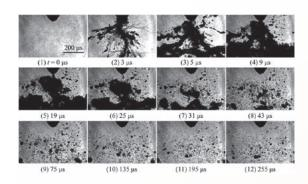
水中プラズマによる微細気泡の生成 Generation of fine bubbles by underwater plasma
