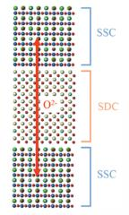
SSC/SDC 複合材内部の酸素イオン輸送 特性の分子シミュレーション
