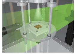
極低温ファイン固体粒子噴霧を用いたナノ デバイスクリーニング
