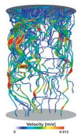
直接シミュレーションによる 流れ場の結果 Simulation result of flow
