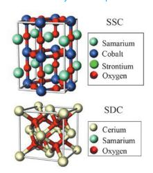
SSC (上) と SDC (下) の単位格子 Unit cell of SSC (upper) and SDC (lower)
