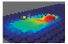
3D printer 用金属粒子のレーザー溶融 プロセスとプパッタ粒子発生メカニ ズム
