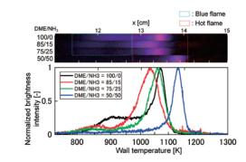
温度分布制御マイクロフローリアクタを用いたジメチルエーテルの反応性に及ぼすアンモニア添加効果の可視化と解析 Visualization and analysis for effects of ammonia addition on reactivity of dimethyl ether using micro flow reactor with controlled temperature profile
