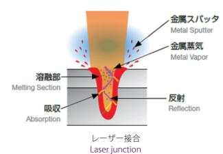
次世代インバータ銅配線の小型化と短時間接合を実現するために、レーザーによる固相から液相への数値解明による溶融接合技術の確立を目指します。
