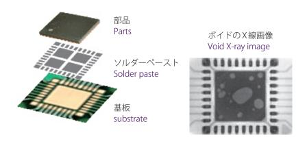
次世代インバータの超小型化を実現するために、はんだ接合部信頼性向上に向け、はんだボイドの発生メカニズムの解明と予測技術の構築を目指します。
