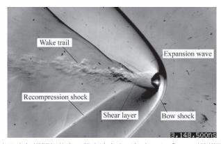
火星大気模擬気体中の超音速自由飛行するカプセル形状模型 Supersonic free-flight of capsule model in CO<sub>2</sub> gas
