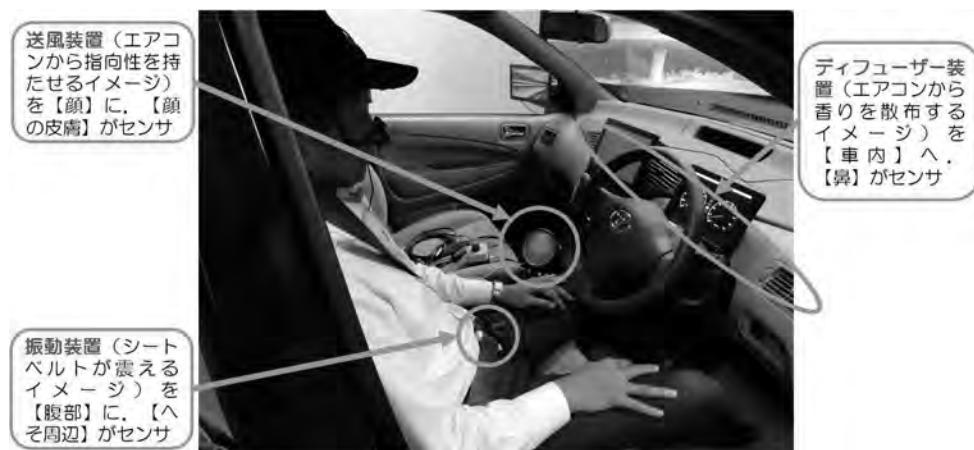
図 10-1 検討した覚醒 HMI デバイス
