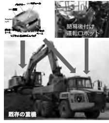
図 9-4 大型ダンプ自動化
