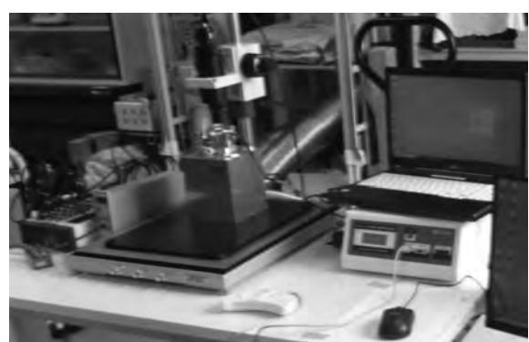
図10 超微量粘度計試作機
