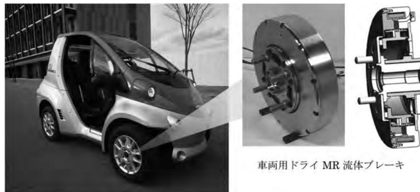
図8-2 四輪にドライMR流体ブレーキを実装した小型EV
