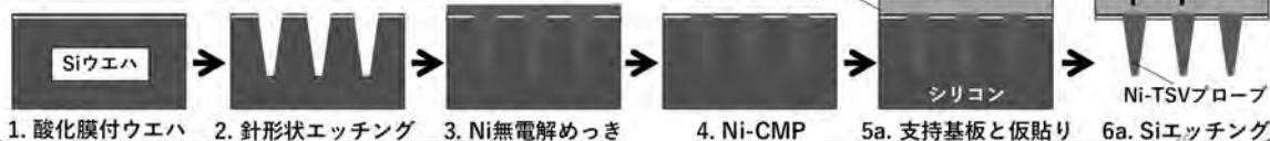
図27 TSV のスケーリングから生まれた半導体ウエハテスト用ナノプローブの作製工程
