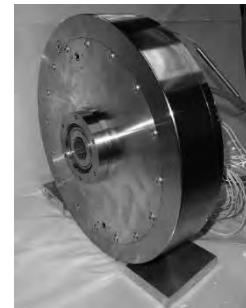
図8-3 ハイブリッド車両用のドライMR流体クラッチ・ブレーキ一体型動力伝達・制動装置
