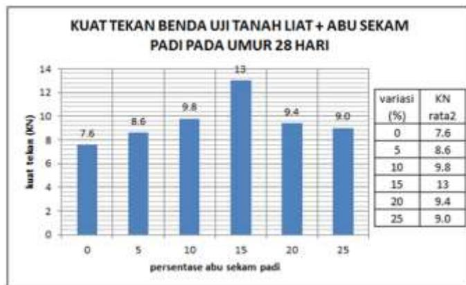
Gambar 3.13: Kuat Tekan Benda Uji T.Liat + ASP Pada Umur 28 Hari
