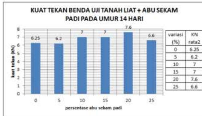
Gambar 3.12: Kuat Tekan Benda Uji T.Liat + ASP Pada Umur 14 Hari
