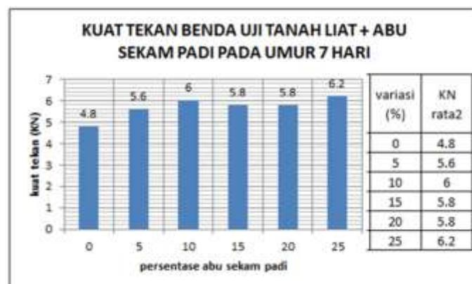
Gambar 3.11: Kuat Tekan Benda Uji T.Liat + ASP Pada Umur 7 Hari
