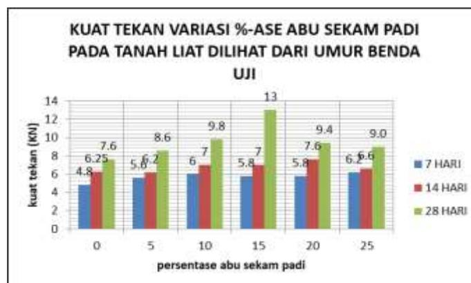
Gambar 3.14: Kuat Tekan Variasi %-ase Abu Sekam Padi Pada Tanah Liat Dilihat Dari Umur Benda Uji
