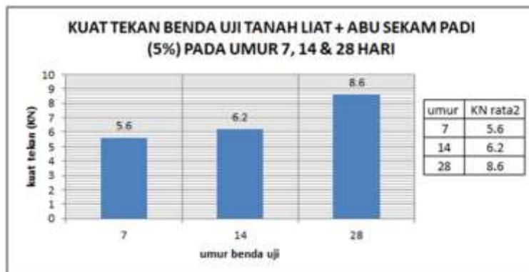
Gambar 3.5:Kuat Tekan Benda Uji Tanah Liat + ASP variasi 5%
