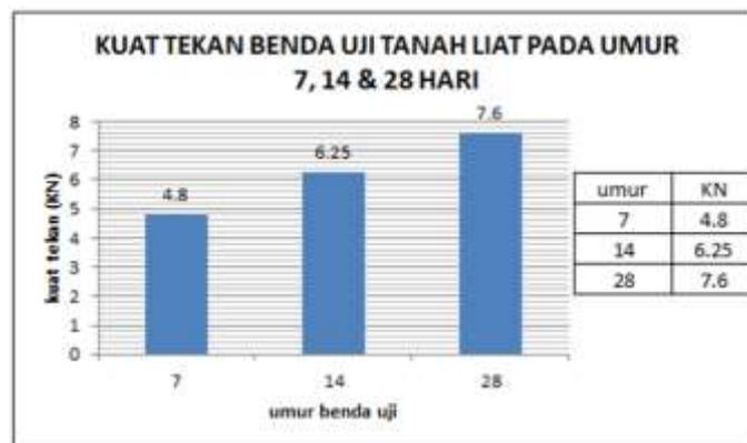
Gambar 3.15: Kuat Tekan Benda Uji Tanah Liat Pada Umur 7, 14, & 28 Hari
