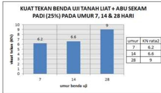
Gambar 3.9: Kuat Tekan Benda Uji Tanah Liat + ASP variasi 25%
