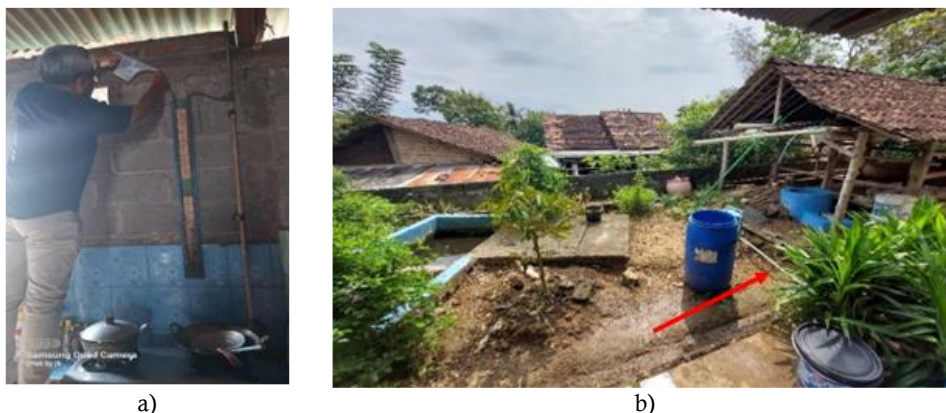
Gambar 8. a) Pengukuran volume biogas yang dihasilkan dengan pengkondisian manometer; b) Input biodigester (kanan) hingga kolam output (kiri), panah merah menunjukkan kran penyalur biogas menuju dapur warga
