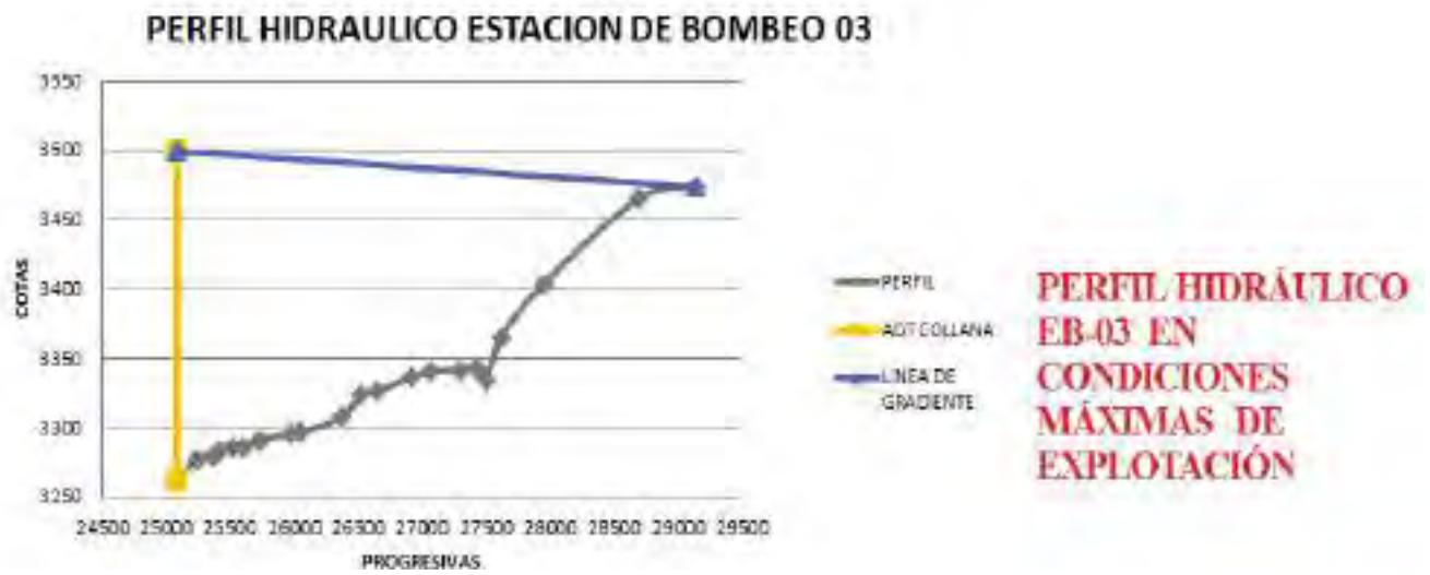
Figura 73 : Evaluación Hidráulica estación de bombeo 03 Collana (Elaboración Propia)
