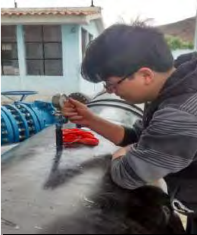
MEDICIÓN DE TRANSITORIO HIDRAULICO INSITU – APAGADO DE BOMBAS – CON MANOMETRO DE GLICERINA
