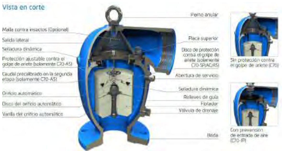
Figura 36 : Válvula de aire anti golpe de ariete – unión bridada (Rec. de https://www.bermad.com/es/ , 2022)
