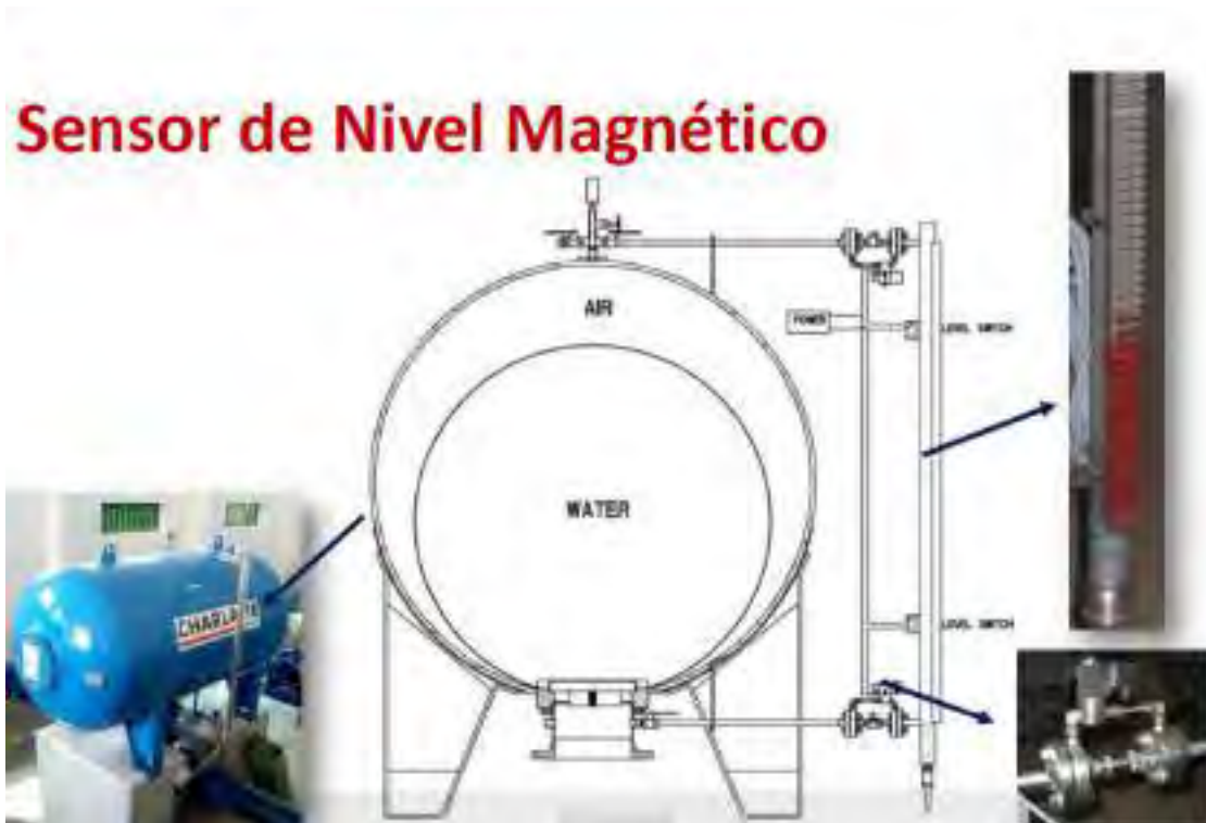
Figura 41 : Características y ventajas de Tanque Antiarriete (Gandarillas I. , 2017)
