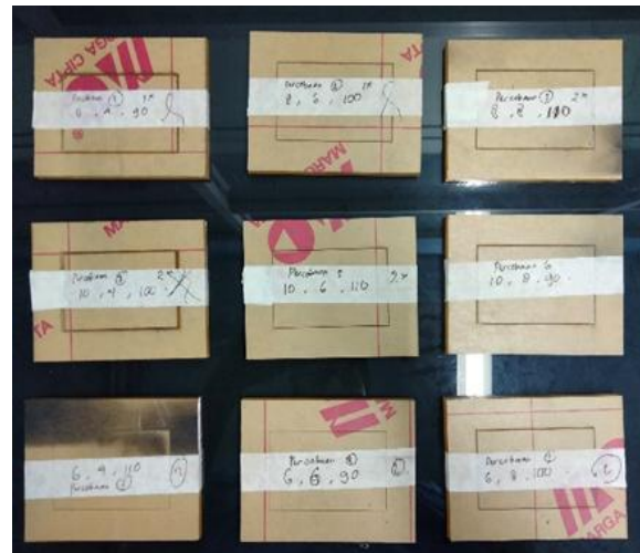
Gambar 7. Hasil Pemotongan Material Menggunakan Laser Cutting
