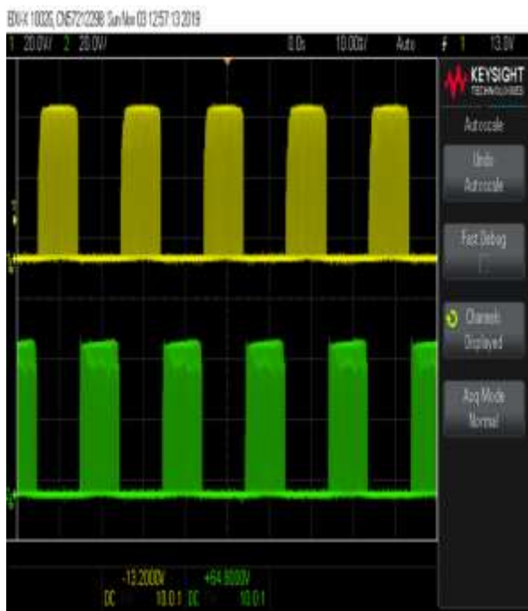
Gambar 2. Kinerja IGBT Q11 dan Q17
