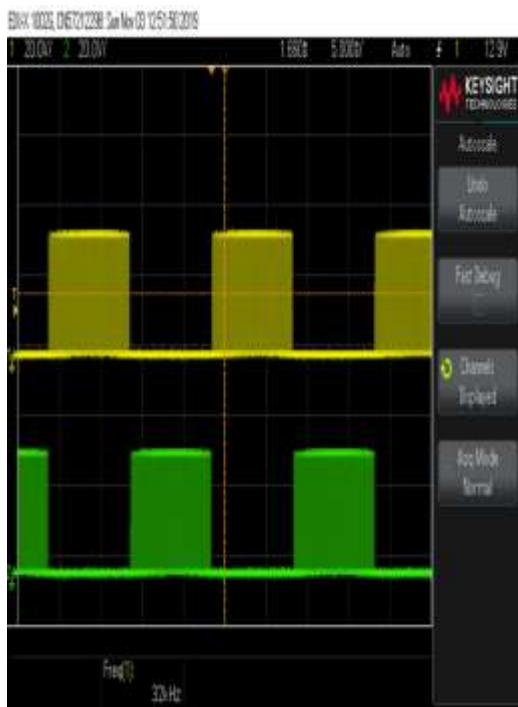
Gambar 6. Sinyal output pin9 dan pin10 mikrokontroler Arduino2 (DUINO2)
