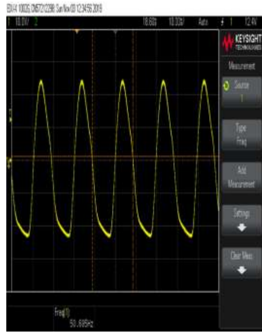
Gambar 7. Sinyal output hasil switching IGBT, Q11, Q12, Q17 dan Q18
