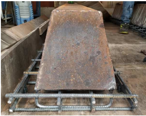
Figura 58: Presentación de los resultados de 2 cuerpos de prueba, se aprecia rotura cónica
