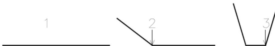
Figura 44: Proceso en 3 pasos, 1 corte, 2 y 3 plegado de la chapa, según una presentación de Phares y otros, 2017
