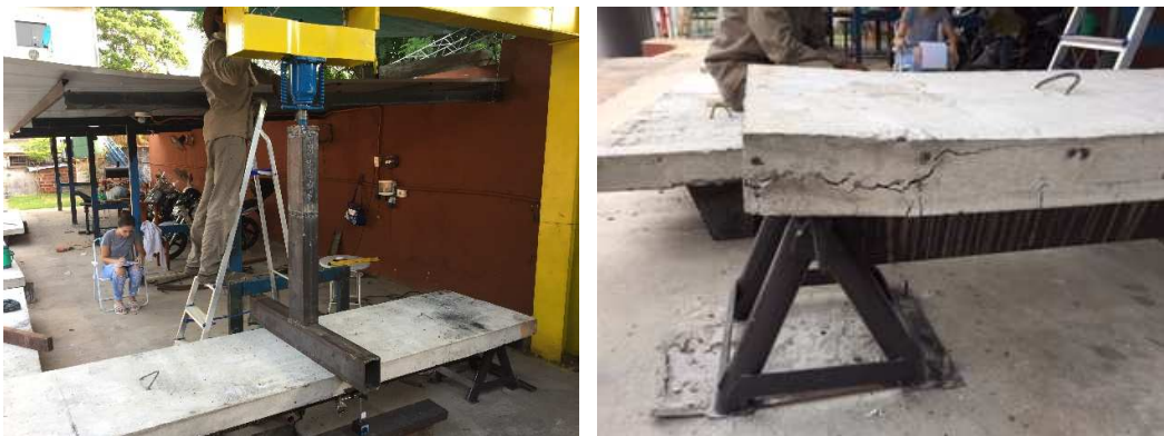
Figura 39: Vista de la colocación de la muestra en posición para la ejecución del experimento y fisuras luego de fallar la pieza. Viga 3, Ho 30 MPa.
