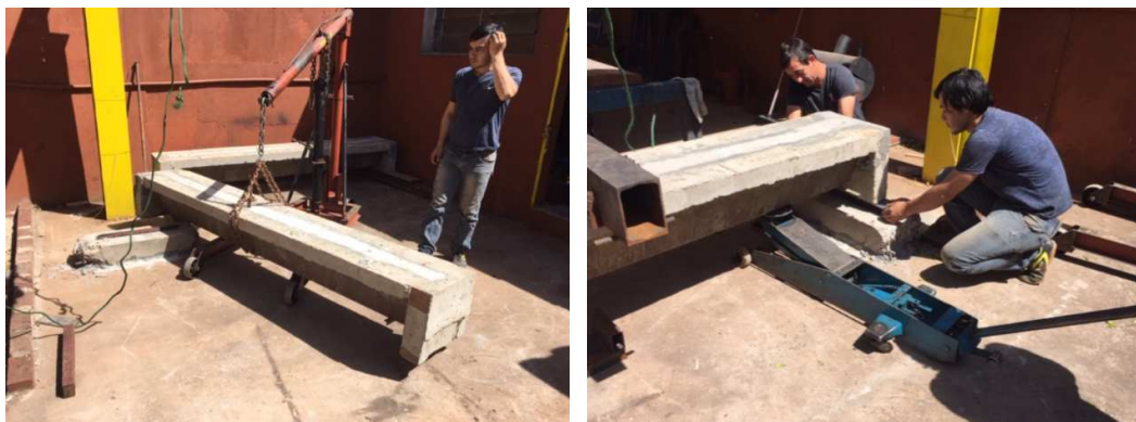
Figura 63: Proceso de colocación de la muestra en posición para ensayo
