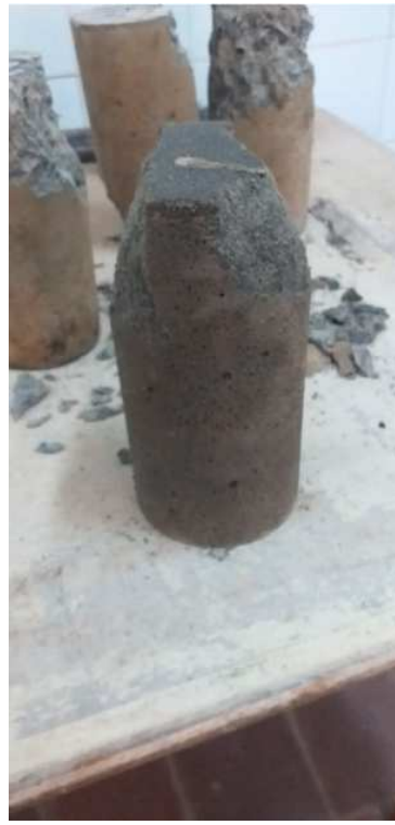
Figura 58: Presentación de los resultados de 2 cuerpos de prueba, se aprecia rotura cónica
