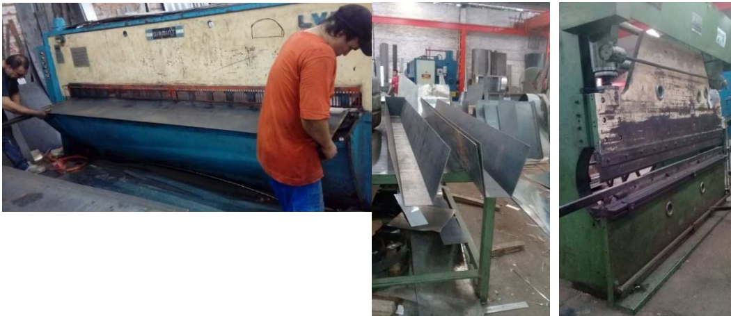
Figura 49: Procesos de corte, producto y dobladora, fotos propias
