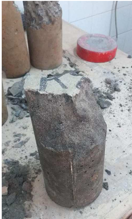
Figura 58: Presentación de los resultados de 2 cuerpos de prueba, se aprecia rotura cónica
