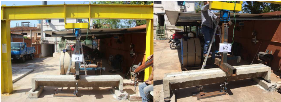
Figura 62: Vista en alzado del pórtico de carga, se muestran las vigas 1 y 2 en posición
