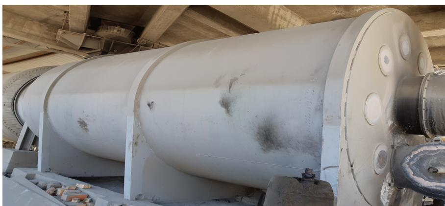
Figura 3.3. Quemador de biofuel. Fuente: INC(2020)
