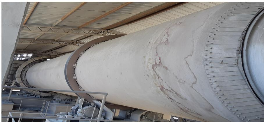
Figura 3.2. Secador rotatorio para puzolana. Fuente: INC(2020)
