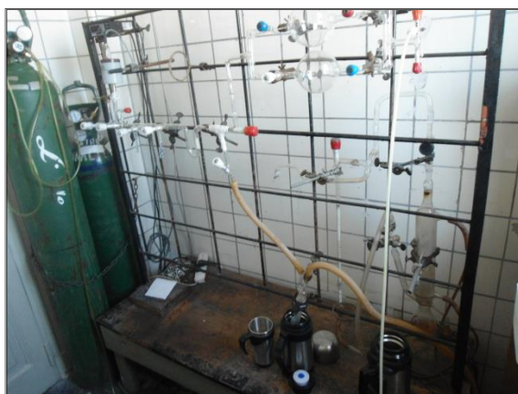
Figura2: Línea de vacío para la carga de reactivos gaseosos.
