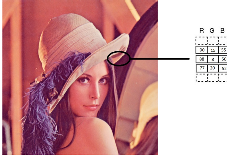
Figura 2.1: Imagen en color de Lenna , en la que cada píxel posee un valor (r, g, b) .
