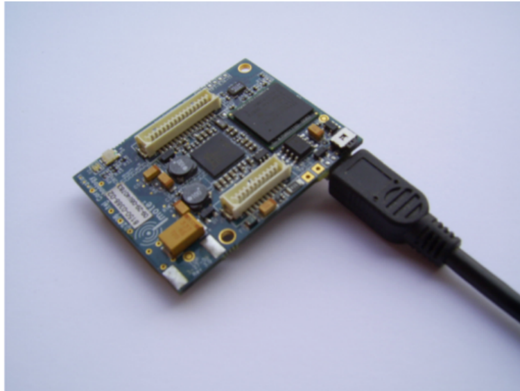
Fig. 2.3: Nodo sensor Imote2, desarrollado por Intel [20].
