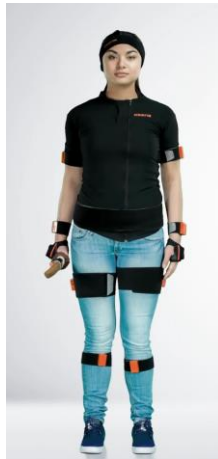
Figura 9. Colocación sensores Xsens. N-Pose[13].
