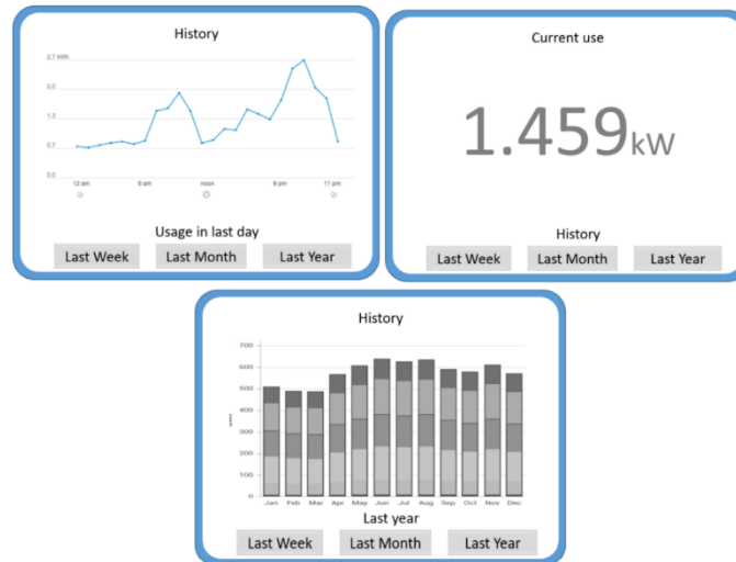
Figura 2. Pantalla de inicio de medidor inteligente
