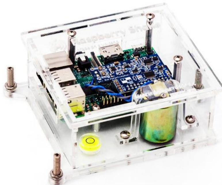
*Figura 20.* RaspberryShake 4D Fuente: (RaspberryShake)
