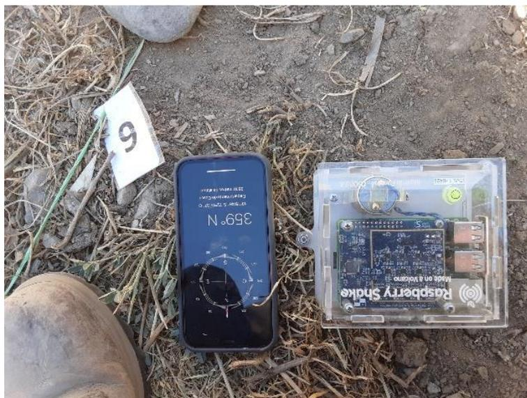
Figura 29. Posicionamiento del RaspberryShake 4D con referencia al norte
