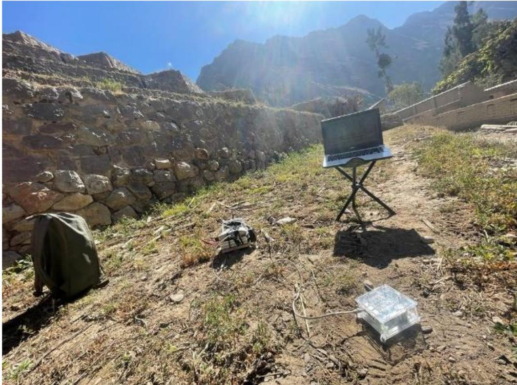
*Figura 34.* Posicionamiento del sismógrafo y grabación de las microtrepidaciones
