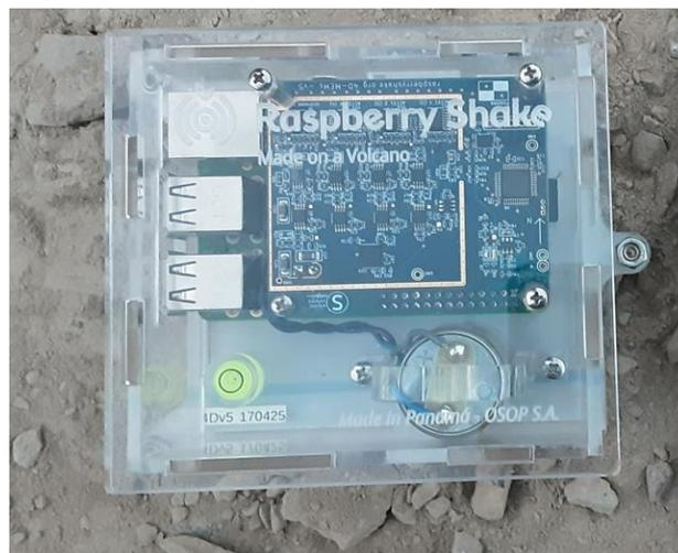
Figura 24. RaspberryShake 4D
