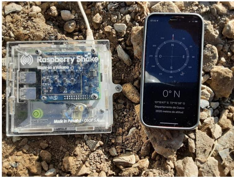
Figura 28. Posicionamiento del RaspberryShake 4D con referencia al norte
