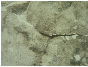
Gambar 8. Retak batas butir, menunjukkan retak tegang
