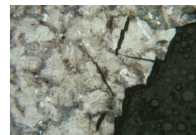
Gambar 7. Struktur mikro daerah patah berupa perlitik dengan austemite (putih) dan bentuk retak transgranular yang menunjukkan adanya beban tarik/bentur yang cukup tinggi
