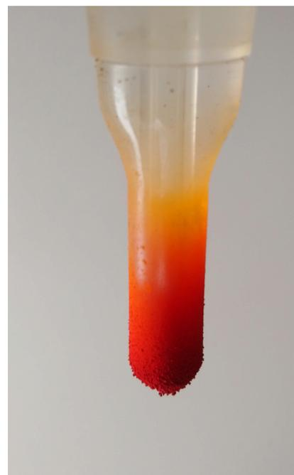
Abb. 4.4: Kühlfinger, welcher bei der Sublimation von  $\text{Fe}(\text{acac})_3$  in einem Dreihalskolben verwendet wurde.
