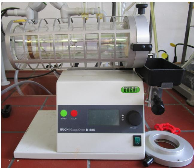
Abb. 4.3: Der für die Sublimationsversuche verwendete Rohrofen der Firma Büchi. Foto aufgenommen vom Institut für Anorganische Chemie.
