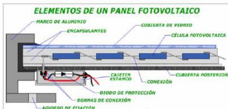
Figura 15- Partes de un panel fotovoltaico.
