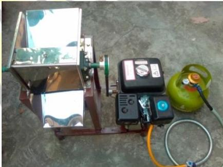
Gambar 6 . Mesin parut kelapa menggunakan bahan bakar LPG 3 kg
