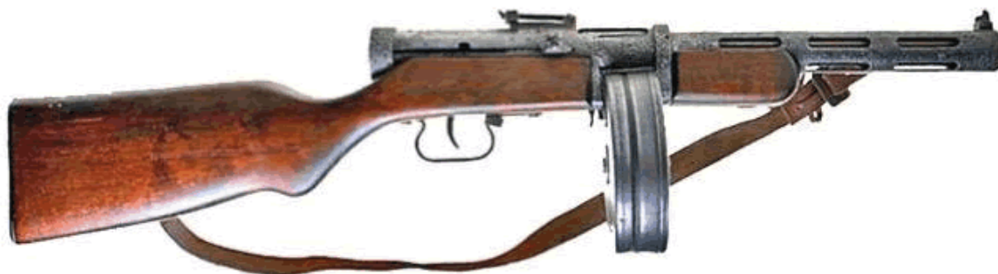
7,62-мм советский пистолет-пулемет системы Дегтярева (ППД-40) образца 1940 г. (длина – 788 мм, масса с патронами – 5,4 кг, емкость магазина – 71 патрон, скорострельность – 900 выстрелов в минуту)
