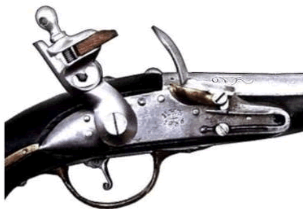
Кремневый замок казачьего солдатского пистолета образца 1839 г.
