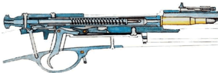
Устройство затвора винтовки Бердана (Berdan rifle)
