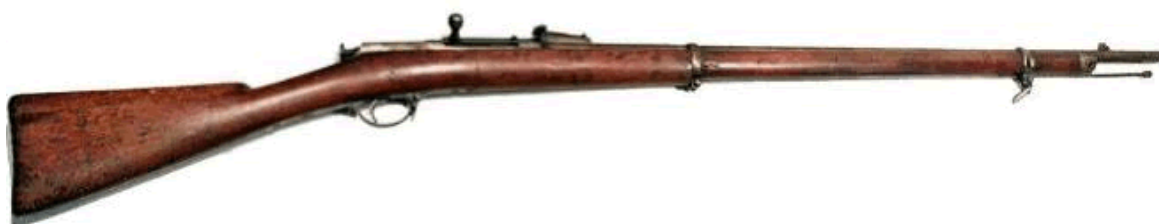
Русская 10,67-мм пехотная винтовка Бердан № 2 образца 1870 г. (длина со штыком - 1850 мм, без штыка - 1345 мм)
