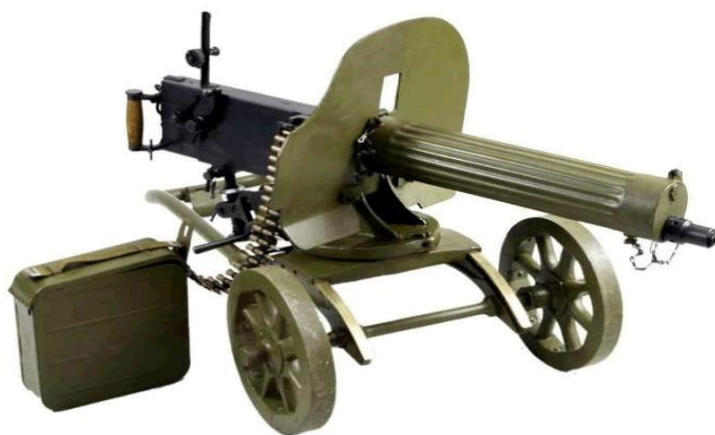
Русский пулемет системы Максима образца 1910 г. на станке Соколова (калибр – 7,62 мм, охлаждение ствола водяное (4 л), масса пулемета без охлаждающей воды – 20,3 кг, вес пулемета со станком – 54 кг, скорострельность 500–600 выстрелов в минуту)
