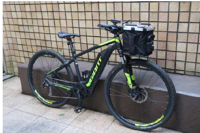
図 5-5 典型的な欧州型電動アシストクロスバイク (GIANT 社“EXPLORER E+3”・2020・筆者撮影)
