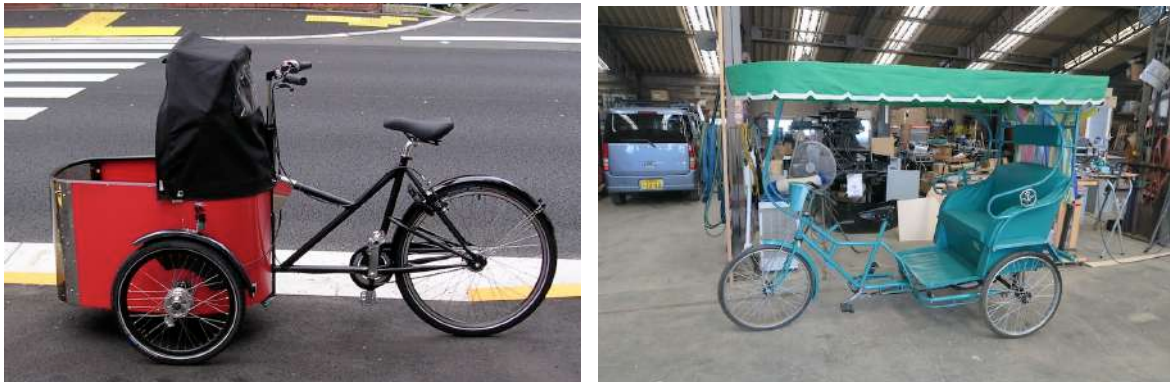
図2-4 左 原始的な前2輪の3輪カーゴバイク「ニホラ」(デンマーク製・NPO自転車活用推進研究会提供・筆者撮影) 右 原始的な後2輪シクロタクシー(ノンブランド中国製・NPOさくらの架け橋会提供・筆者撮影)
