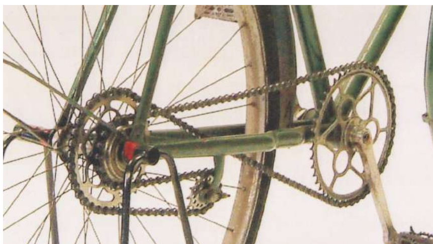
図1-2 1889年の「レトロダイレクト型」と呼ばれるシステム。 フランス人のポール・ド・ヴィヴィエにより開発された(自転車文化センター谷田貝一男氏提供)。
