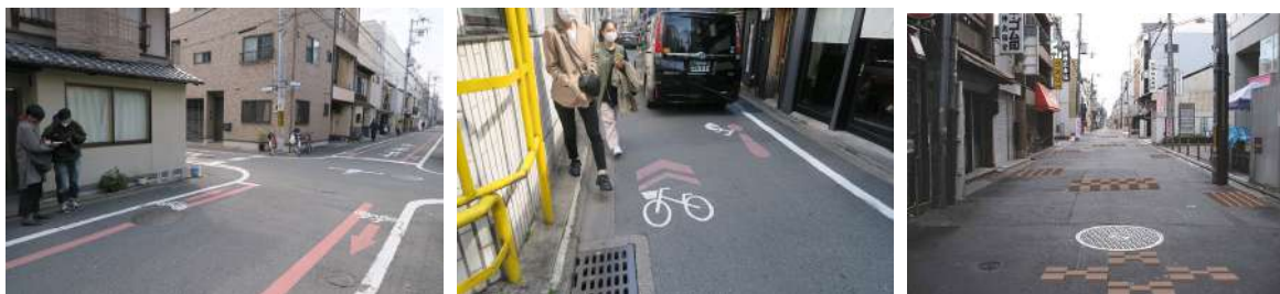
図4-14 京都の細街路ピクトグラム(筆者撮影) 左・エリア内の縦横に自転車ピクトグラム 中・ここまで狭い細街路にも 右・クルマのスピードを落とすための錯視ペイント
