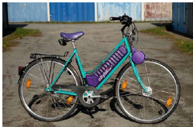
図 5-4 トルクセンサーを持たない“Pedelec” (ドイツ Diamant 社の City-Blitz 1992・谷田貝一男氏提供)
