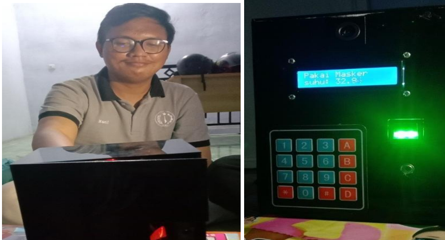
Gambar 9. Keadaan jika seseorang tidak masker dan Perintah memakai masker LCD I2C akan memunculkan suatu perintah “pakai masker”
