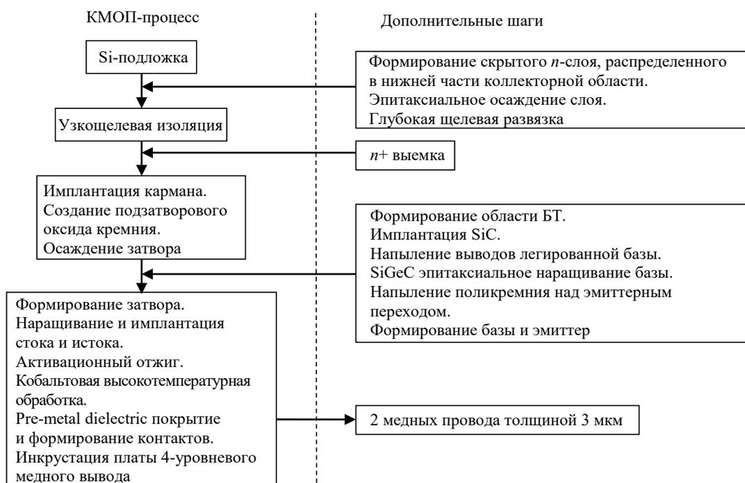
Рис. 16. 0.13-мкм технология интеграции биполярного транзистора в КМОП-процесс (БиКМОП) [50]
