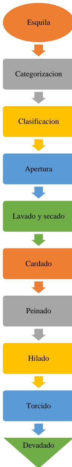
**Ilustración 7-1:** Diagrama de bloques del proceso textil de transformación de la fibra de alpaca.
