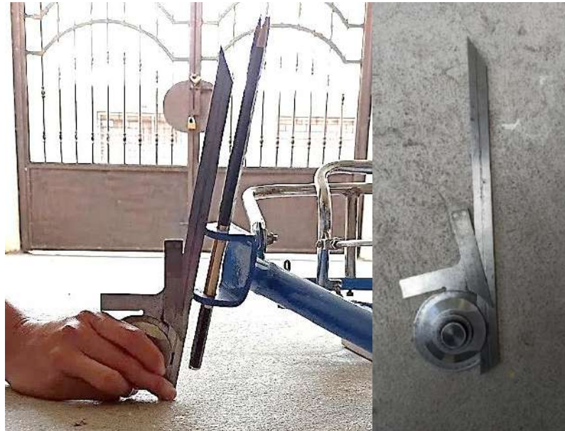
Ilustración 4-3: Medición del ángulo de salida
