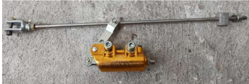
Ilustración 30-3: Bomba de freno de cilindro maestro y varilla de freno
