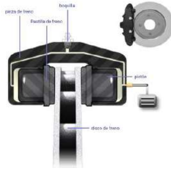
Ilustración 20-2: Pinza de freno fija
