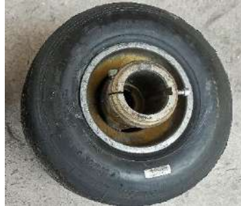
Ilustración 24-3: Neumáticos de 11 pulgadas, marca Breagstone
