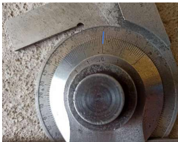
Ilustración 6-3: Medida del ángulo de avance
