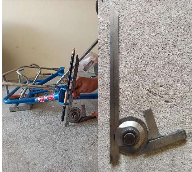
Ilustración 5-3: Medición del ángulo de avance o caster.
