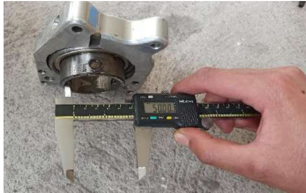
Ilustración 26-3: Medida del diámetro interno de la chumacera
