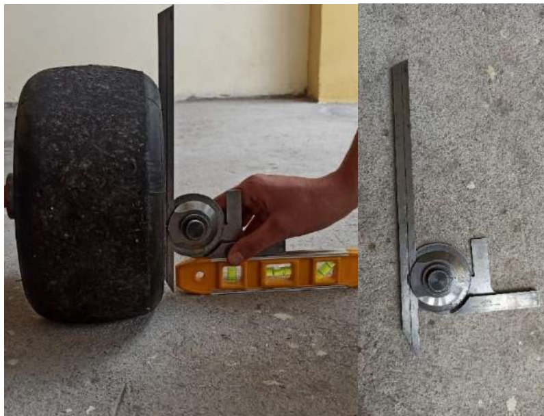
Ilustración 3-3: Medición del ángulo de caída o camber.
