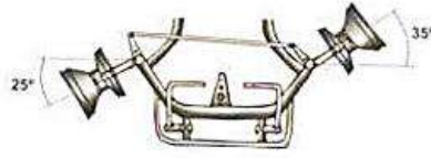
Esquema del tren delantero de un kart mostrando el efecto Ackerman
