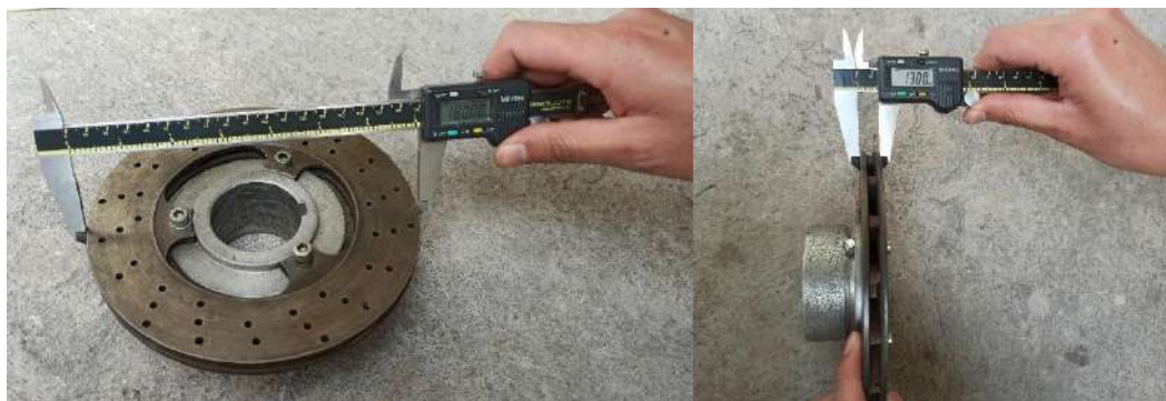
Ilustración 29-3: Medición de disco de freno ventilado OTK 180x13 mm
