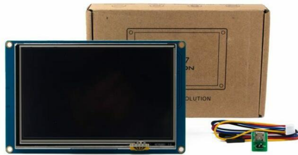
Figura 10-2: Pantalla Nextion de 3,5 pulgadas
