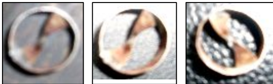
Gambar 1. Turbulator dengan sudut kemiringan bilah 30°, 45°, dan 60°
