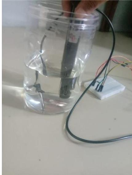
Gambar 4. Pengujian sensor suhu DS18B20
