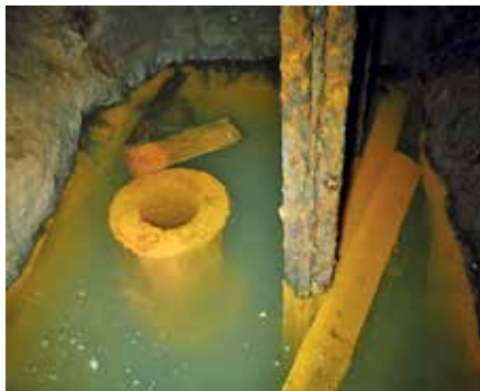
Blick auf das heute überflutete Steigrohr mit Gestänge.
