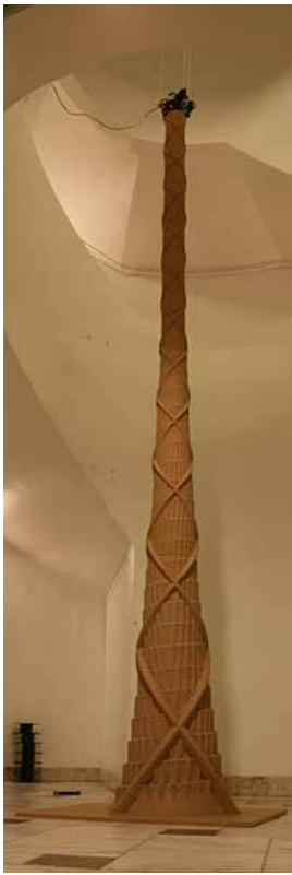
Vier Meter hoher Turm von Babel, mit einem Hangprinter hergestellt
