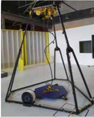
3D-Drucker nach Fused Filament Fabrication mit spezieller Delta-Kinematik in der Ausstellung MaschinenBoom.
