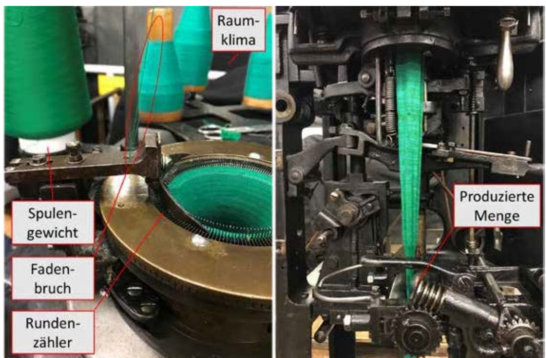
Zu ermittelnde Größen an der Rundstrickmaschine: Raumklima, Spulengewicht, Fadenbruch, Rundenzähler sowie produzierte Menge
