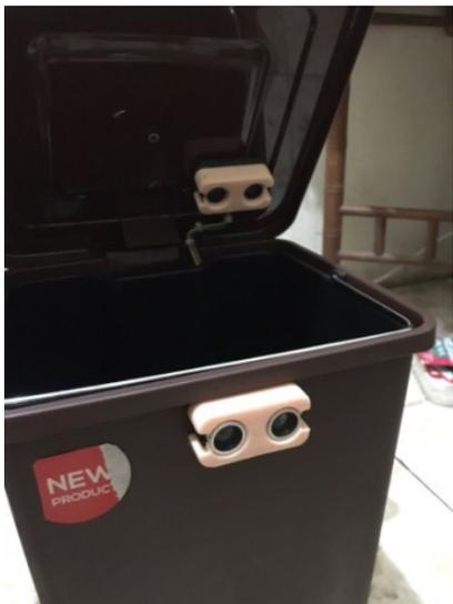
Gambar 5. Pemasangan Sensor Ultrasonik HC-SR04
