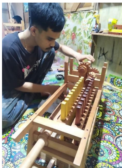
Gambar 8 Merangkan dan melumasi komponen Sumber: Dokumentasi pribadi
